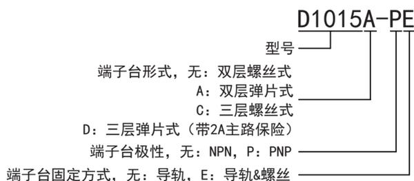
注：带 E 安装左右中心距 = 端子台长度 + 7.7mm
